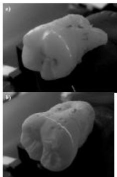
Rys 6.: Zdjęcia badanego zęba. Jasna zakrzywiona linia to odbita wiązka lasera. a) Ząb o niezmodyfikowanej powierzchni; b) ząb o zmodyfikowanej powierzchni w celu zwiększenia odbicia rozproszonego.
